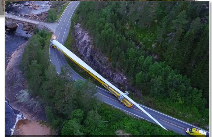
Transport av 70 meter lange turbinblader til Tronstad vindpark
